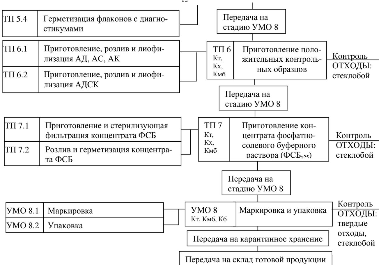
Рис. 3. Технологическая схема производства тест-набора «ТН-ДСК-КОА»
