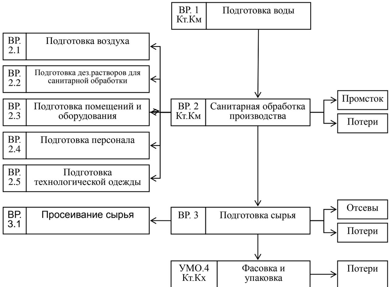
Рис.4. Технологическая схема производства «сухих концентратов» - порошков для приготовления растворов для электрофореза
