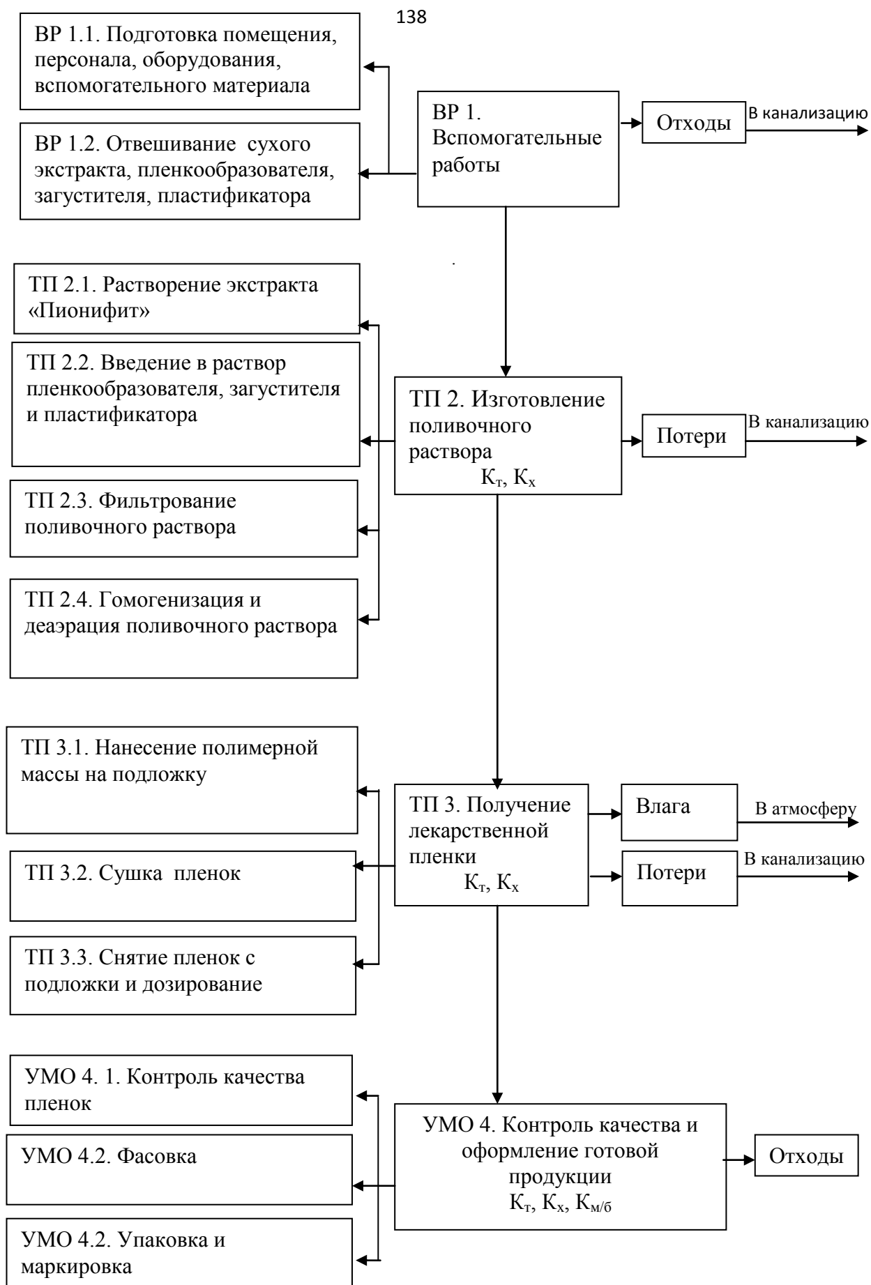
Рисунок 29 – Технологическая схема получения ПЛ «Пионифит» ( K_t – контроль технологический, K_x – контроль химический, K_{м/б} – контроль микробиологический).
