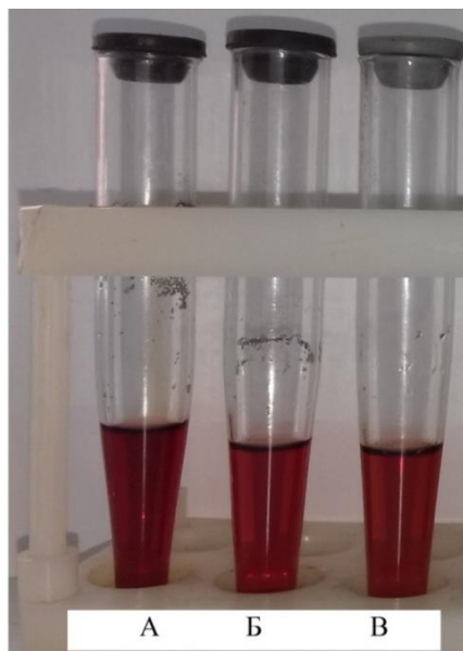
Рисунок 3.4.1.1 – Качественная реакция на флавоноиды с порошком магния и кислотой хлористоводородной (А – извлечение из липы цветков, Б – липы сердцевидной цветков экстракт жидкий 1:1, В – липы сердцевидной цветков экстракт жидкий 1:1,8)
