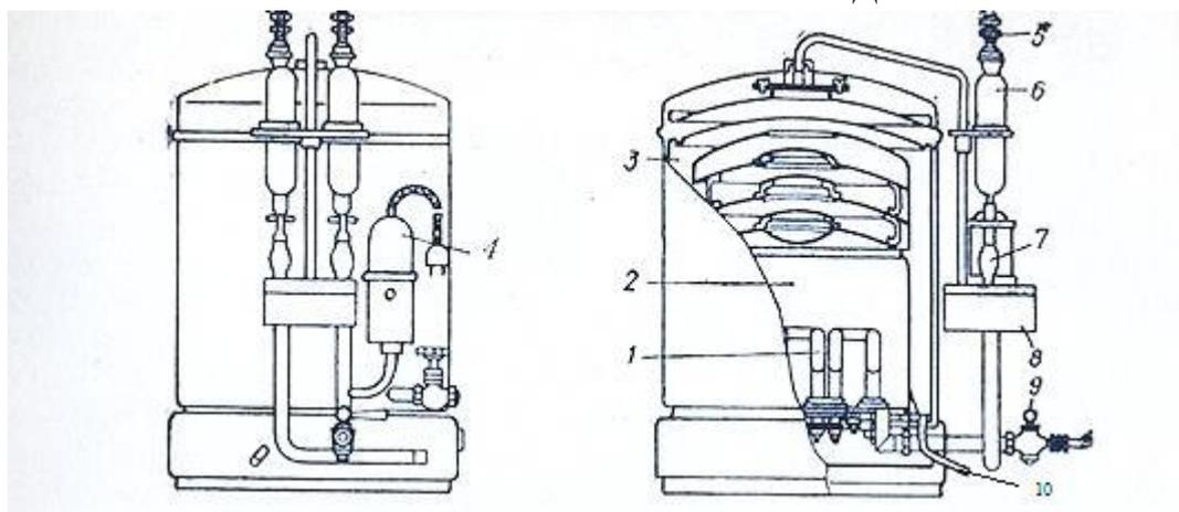
Рис. 1. Аквадистиллятор А-10 для получения воды для инъекций
